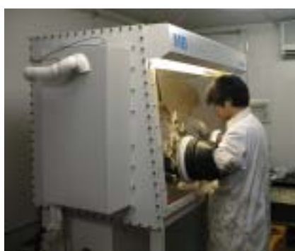
グローブボックス：空気や水のない世界でものづくりを行うための機器
