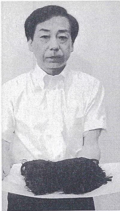
有害な窒素酸化物の除去に期待が高まる高活性炭素繊維（ACF）。見た目は髪の毛に似ている
