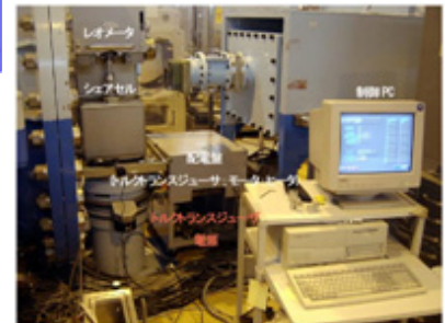
流動中性子散乱測定 (東海村 JRR3M)
