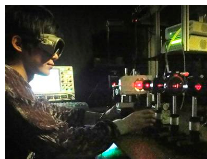
ブルー相を用いた光シャッター の応答速度測定
