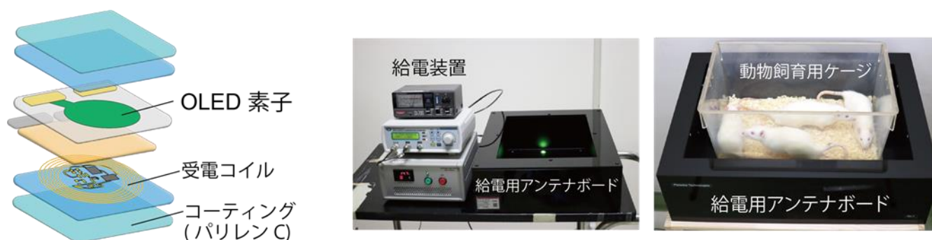
図1. 本研究で創製した無線給電型OLEDデバイス(左)と無線給電システム(右) ※ APL Bioengineering 論文中のFigure 2を改変の上転載
